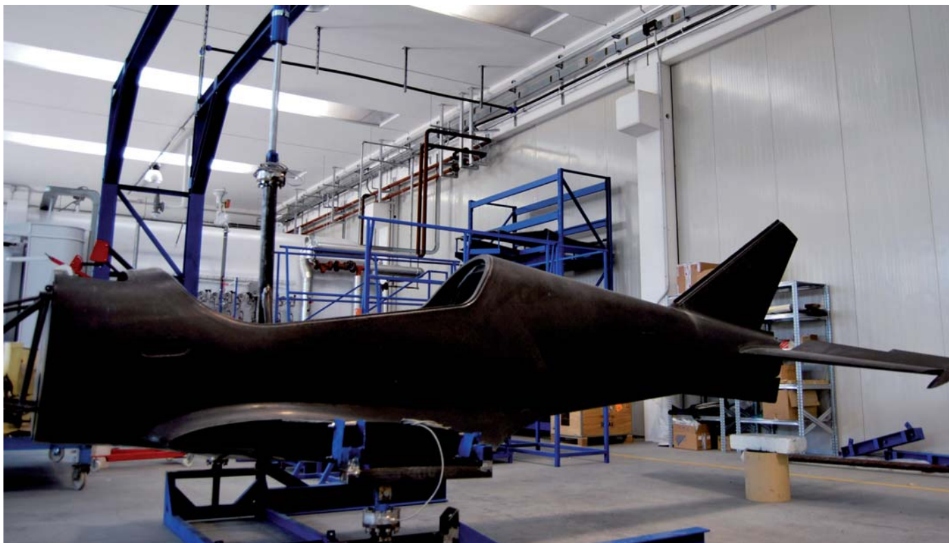
Nella foto fusoliera in fibra di carbonio - Modello Prime della Blackshape Spa
